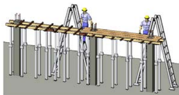
Immagine 02 Posa banchinaggio trave orizzontale
